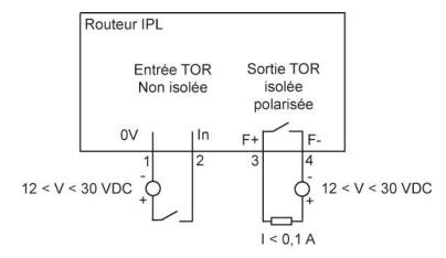
L'entrée tout ou rien permet au routeur d'émettre une alarme par e-mail ou bien de commander la connexion du routeur à l'Internet.
