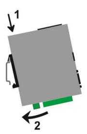
Pour démonter le produit du rail Din 35 mm,
